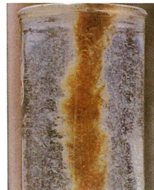
リングレース接触材の汚泥付着状況
